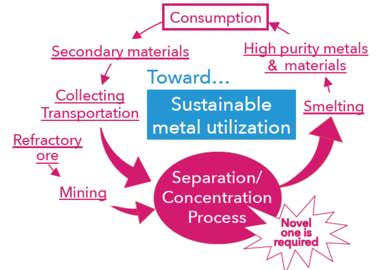
廃棄物や鉱石を固体のままで分離濃縮する省エネルギー型プロセスの研究開発を行っています。このような固体分離濃縮技術は、高温や薬剤で溶かして高純度の金属を生産するプロセスの「前処理」あるいは「中間処理」に位置しています。
