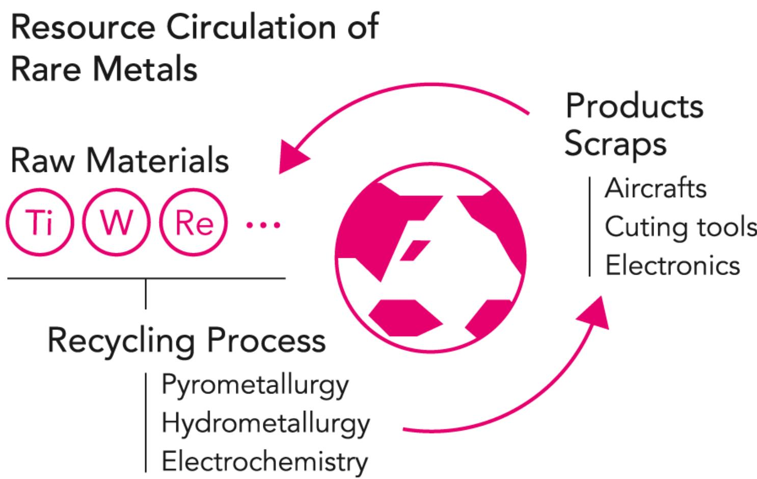
構造材として需要の増大が見込まれるチタン、工具材料として欠かすことができないタンクスチタンとコバルト、ニッケル基超合金に使われるレニウム、自動車排ガス浄化触媒に含まれる白金族金属などに注目し、新規な高効率かつ環境調和型のリサイクル技術の開発を行っています。
